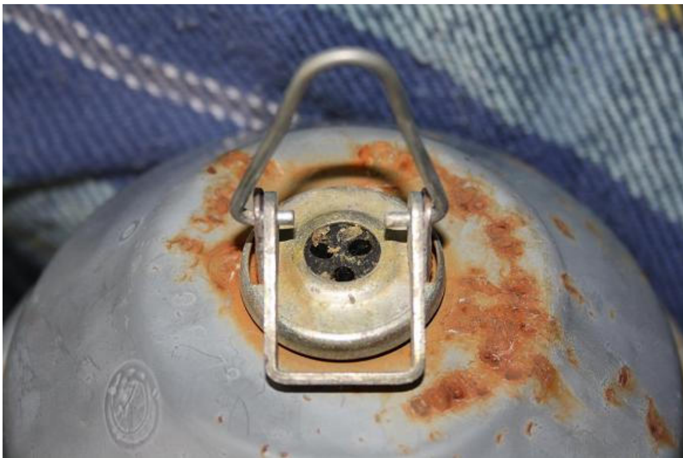
Рис. 23. Типовая горловина НСП02 (версии 3) 1982-1984 годов выпуска.
