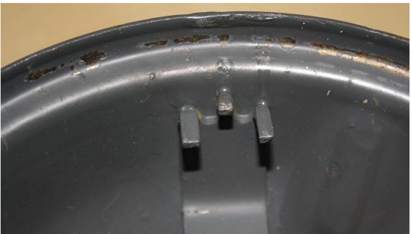
Рис. 10. НСП02100Р5103У5 1975 год (РУПП ВОС). Штырьки для фиксации светоотражающего диска.
