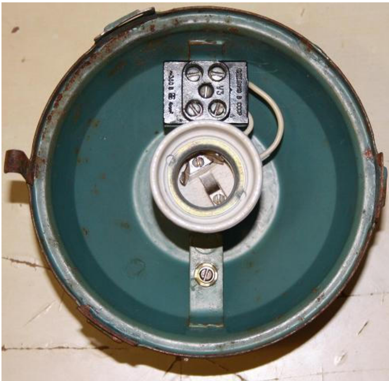
Рис. 38. Светильник НСП02-100-001 У2 (08 1988) (МУПП ВОС). Внутреннее устройство.
