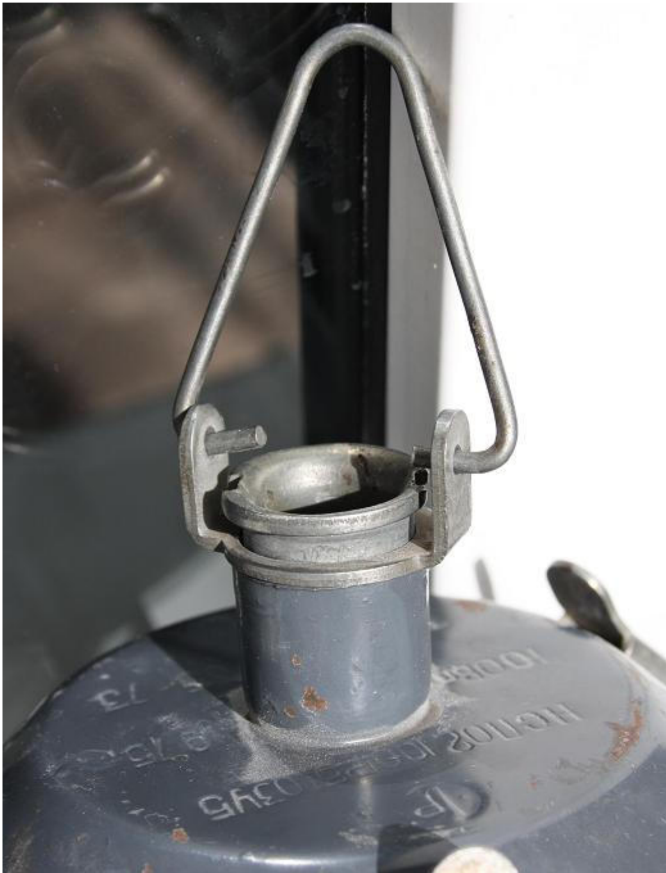
Рис. 6. Крупный план типовой горловины светильников НСП02 Версии 1. (1974-1978 годов).
