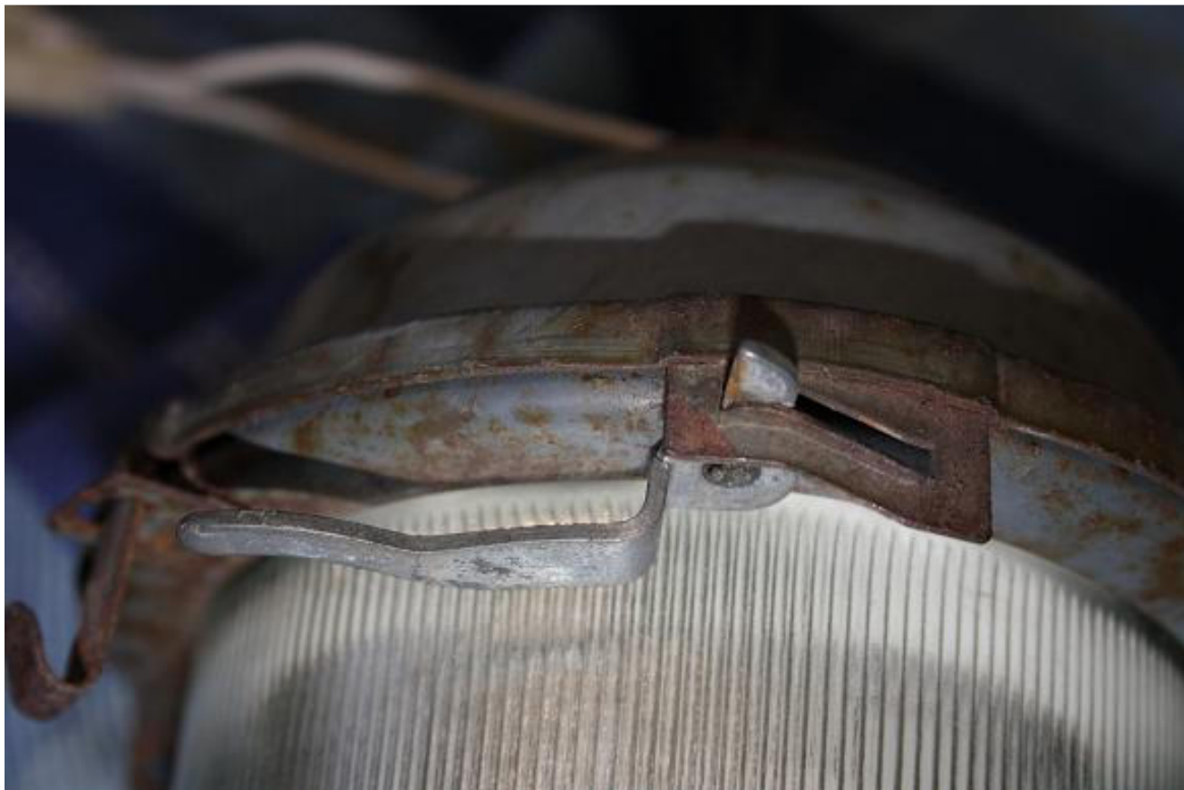
Рис. 25. Замок-задвижка с петлей светильников НСП02 (версии 3) 1982 и начала 1983 годов выпуска.
