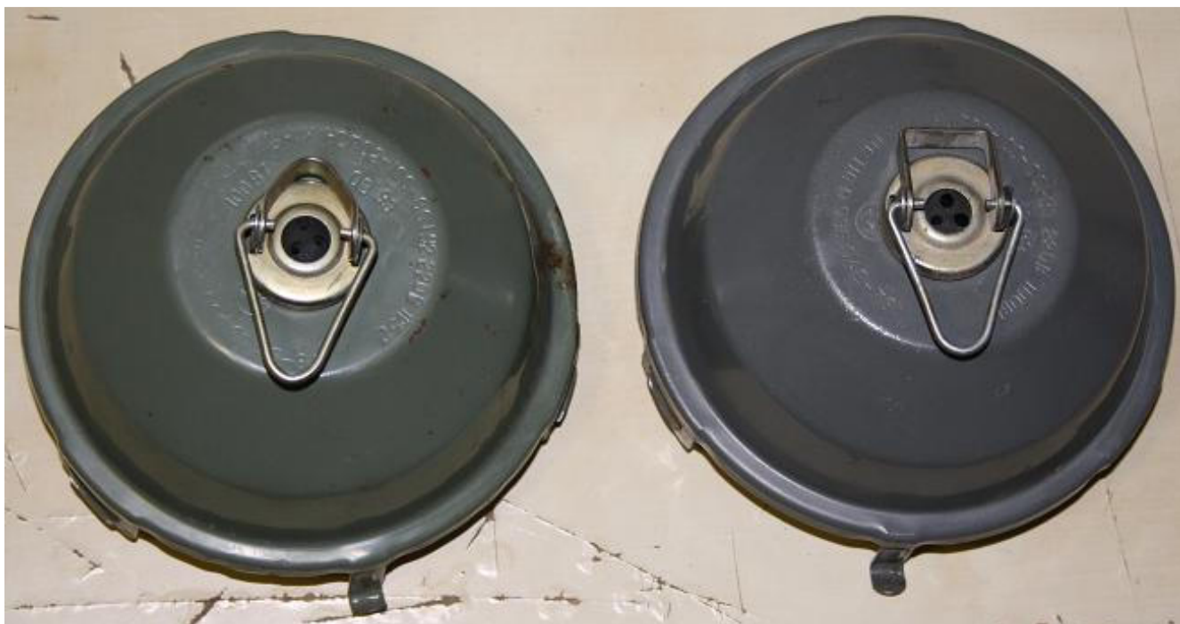
Рис 36. Сравнение прижимных рамок горловин НСП02: версия 4 (слева), версия 3 (справа)
