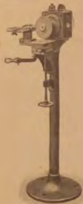
Машина для шлифовки инструментов № 325.
