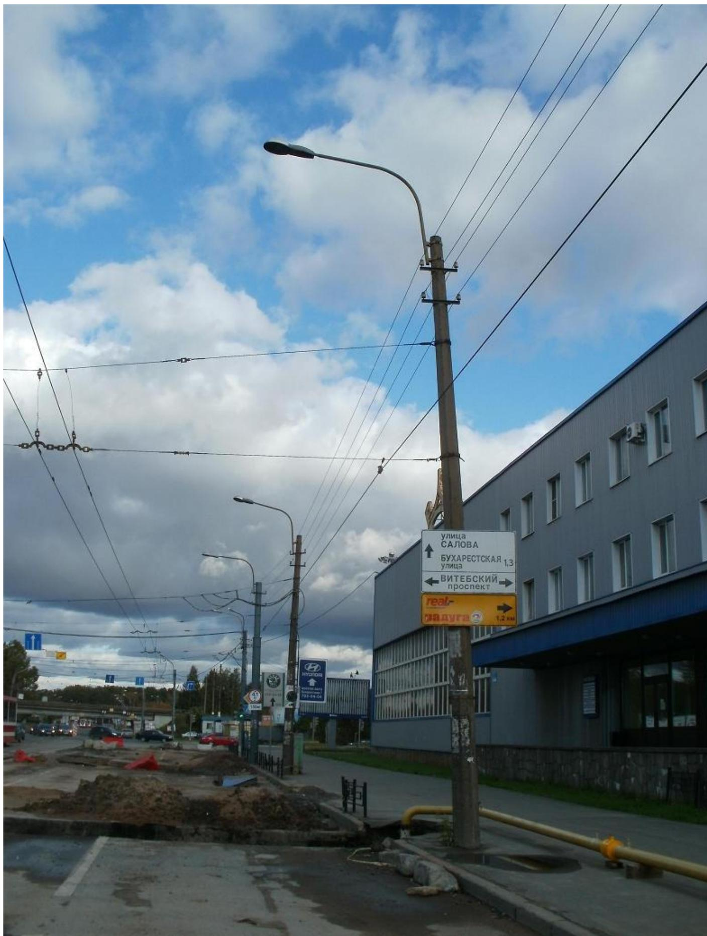
Рис. 89. Линия образца конца 1980-х годов со светильниками ЖКУ03-400-004. Благодатная улица.
