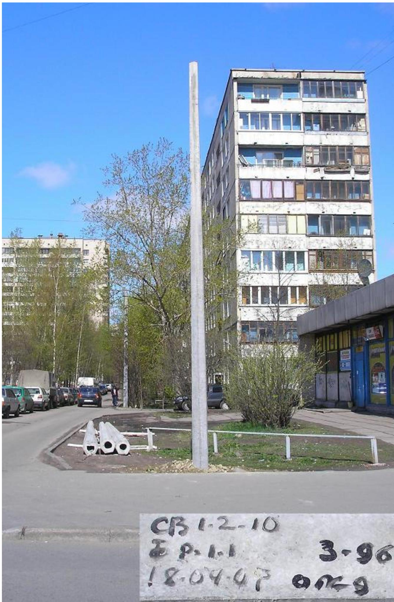
Рис. 80. Пустой столб СВ 1,2-10 и его маркировка. Фотография 1 мая 2007 года.
