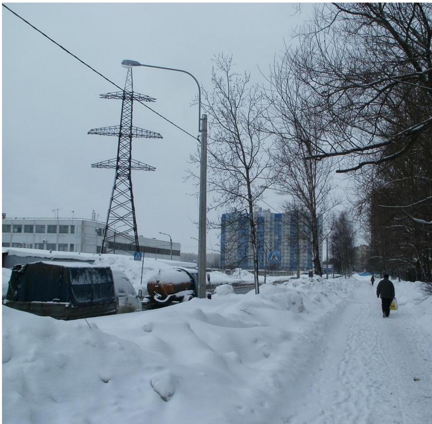
*Рис. 103. Линия уличного освещения с СИП на столбах СВ 1,2-10 и светильниками ЖКУ15. Малая Балканская улица.*
