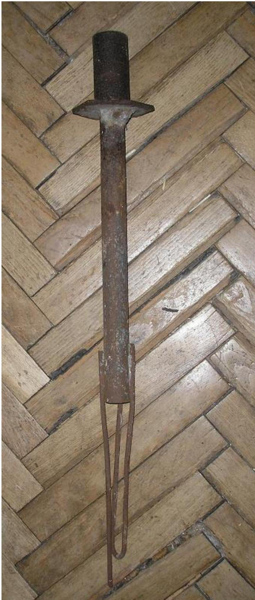
*Рис. 17. Штырь столба с шайбой и корнями, отбитый от бетона.*
