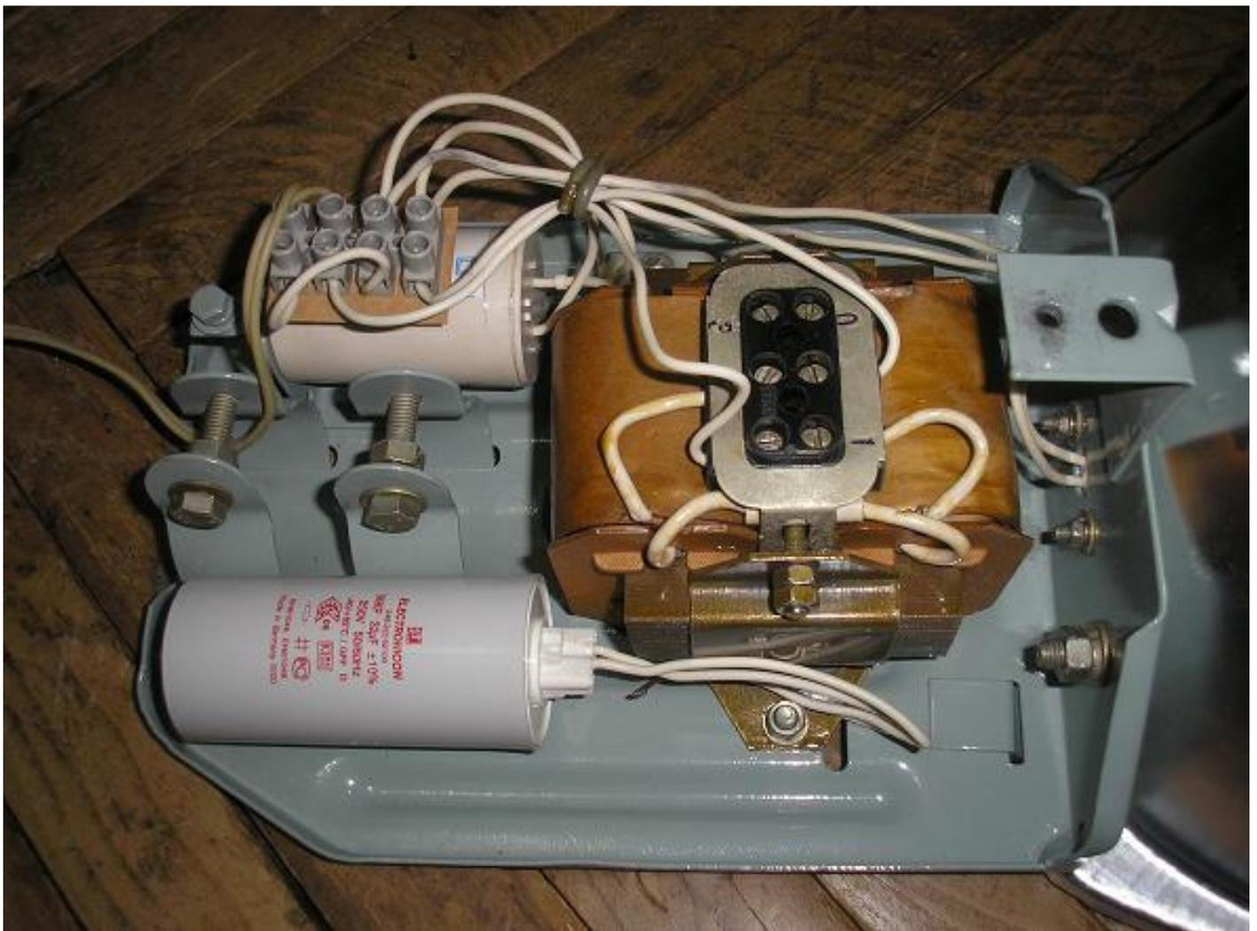
*Рис. 101. Внутренности светильника ЖКУ16-250-001. Конденсатор, ИЗУ и дроссель.*
