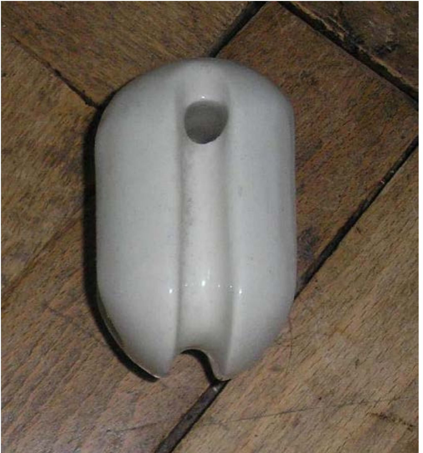
Рис. 125. Такелажный изолятор ИТО с отверстиями (модификация конца 1980-х годов). Крупный план. Из личной коллекции светотехники.
