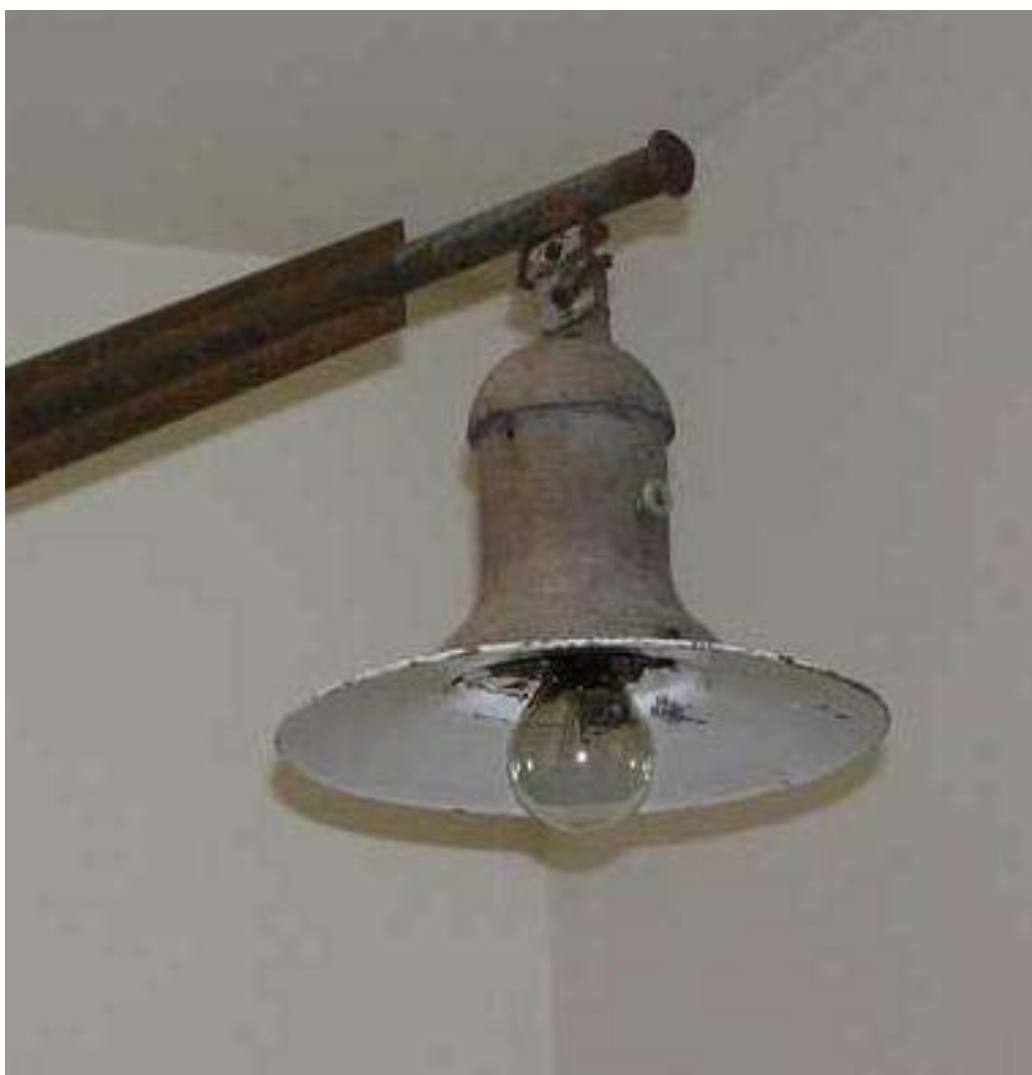
Рис. 55. Светильник СПУ-300 на базе чугунного колокола без стекла. Частная коллекция Сергея Колесникова.
