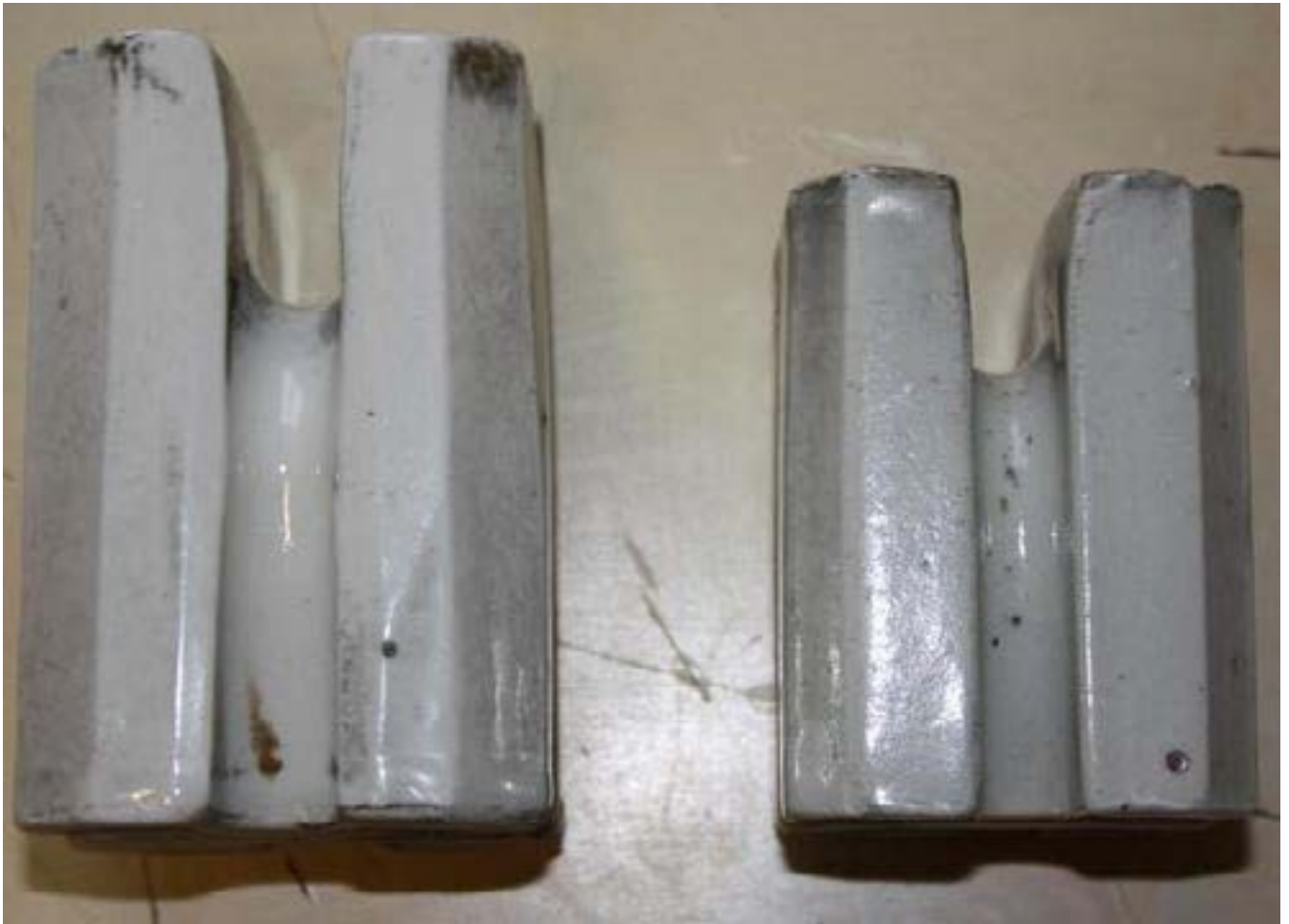
Рис. 48. «Большой» (слева) и «стандартный» (справа) прямоугольные изоляторы. Из личной коллекции светотехники.
