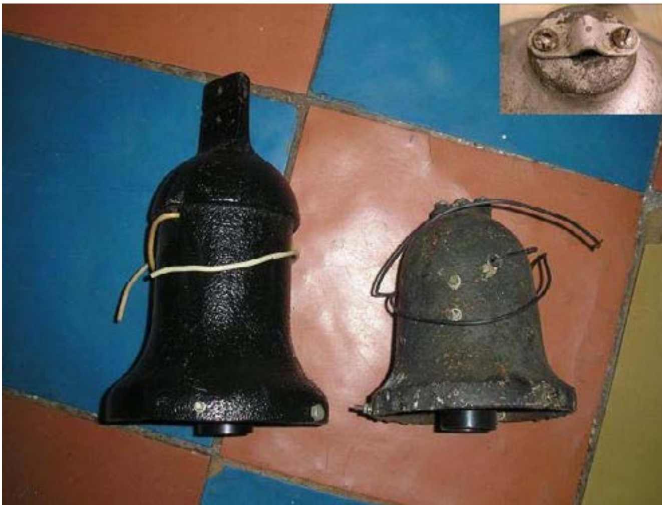
Рис. 70. Отличительные особенности колоколов СПУ-300 и СПО-200. Из личной коллекции светотехники.
