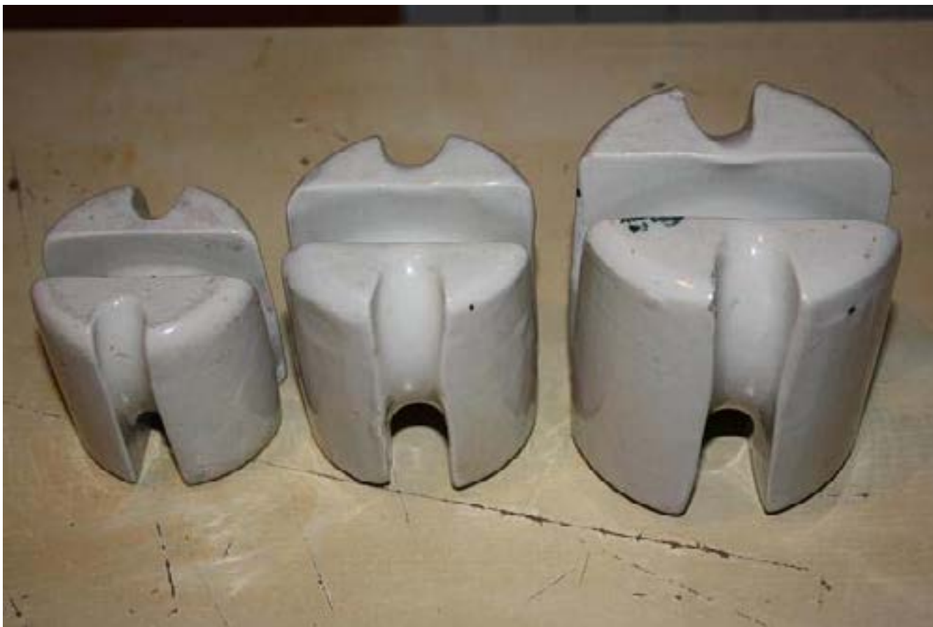
Рис. 90. Изоляторы ИТ-30, ИТ-40, и ИТ-70 крупным планом. Из личной коллекции светотехники.
