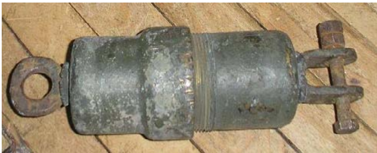
Рис. 53. Латунный бочонковый шумоглушитель типа «колечко-петля». Из личной коллекции светотехники.
