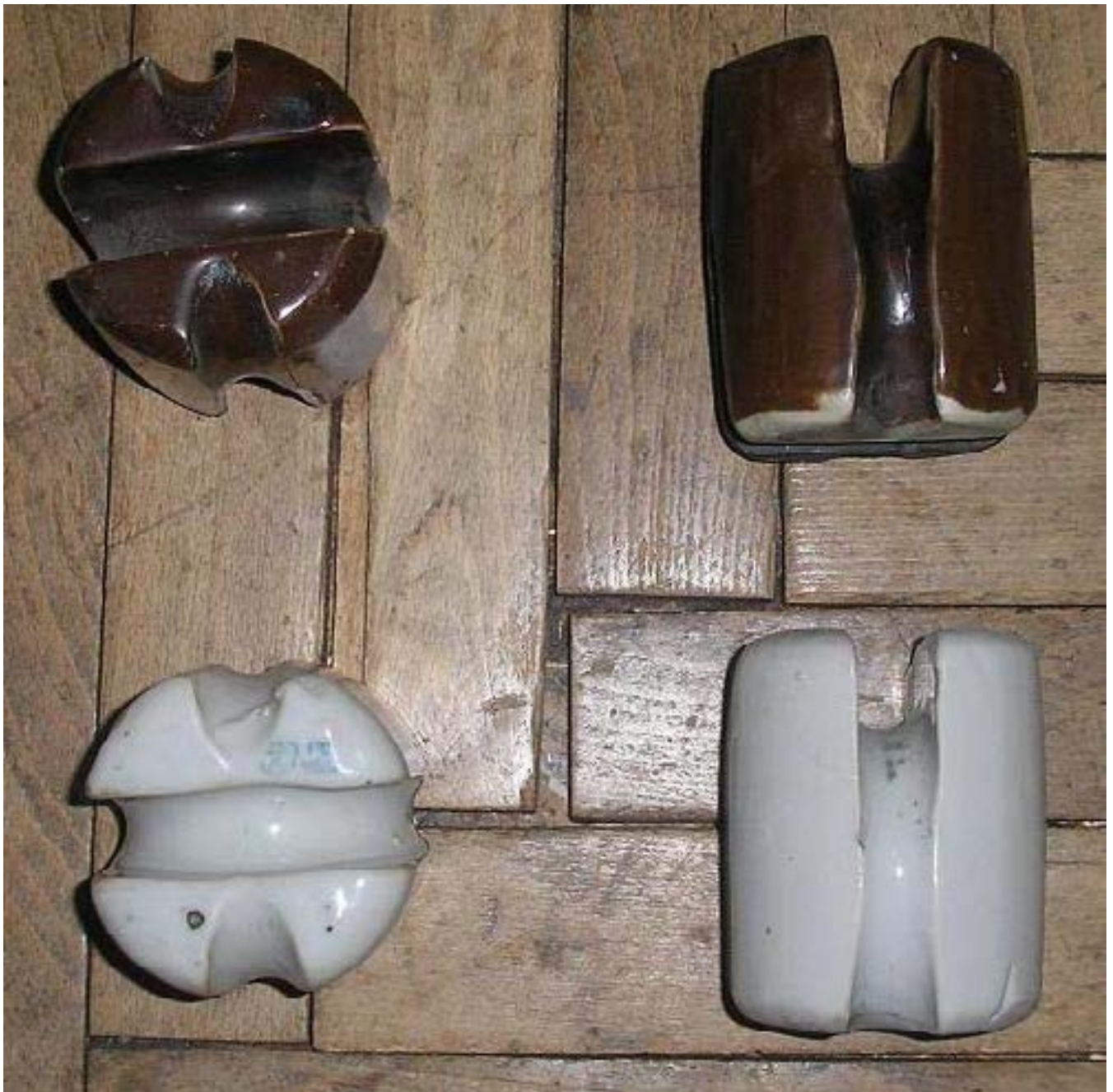
Рис. 91. Изоляторы ИТ-40 в коричневой и белой глазури. Из личной коллекции светотехники.
