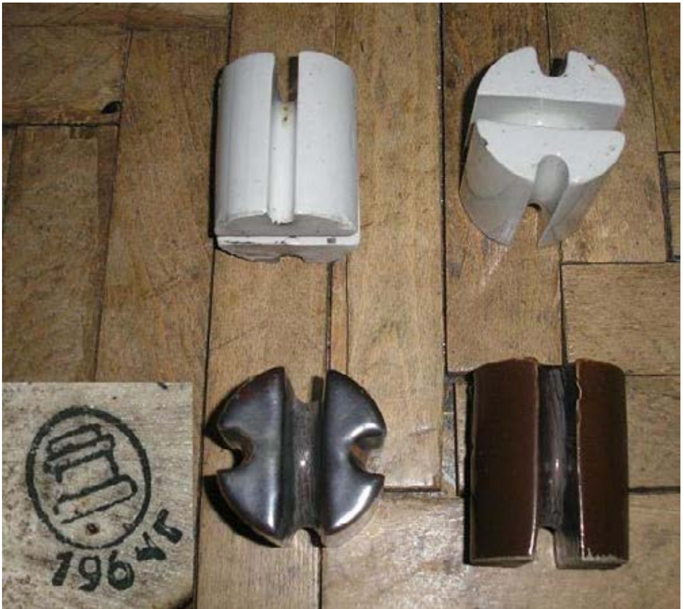
Рис. 49. Белые и коричневые цилиндрические такелажные изоляторы. Из личной коллекции светотехники.
