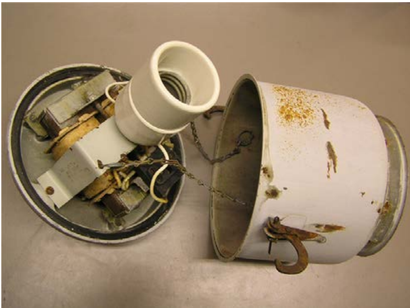
Рис. 101. Внутренности светильника СПОР-250 (версия 2).
