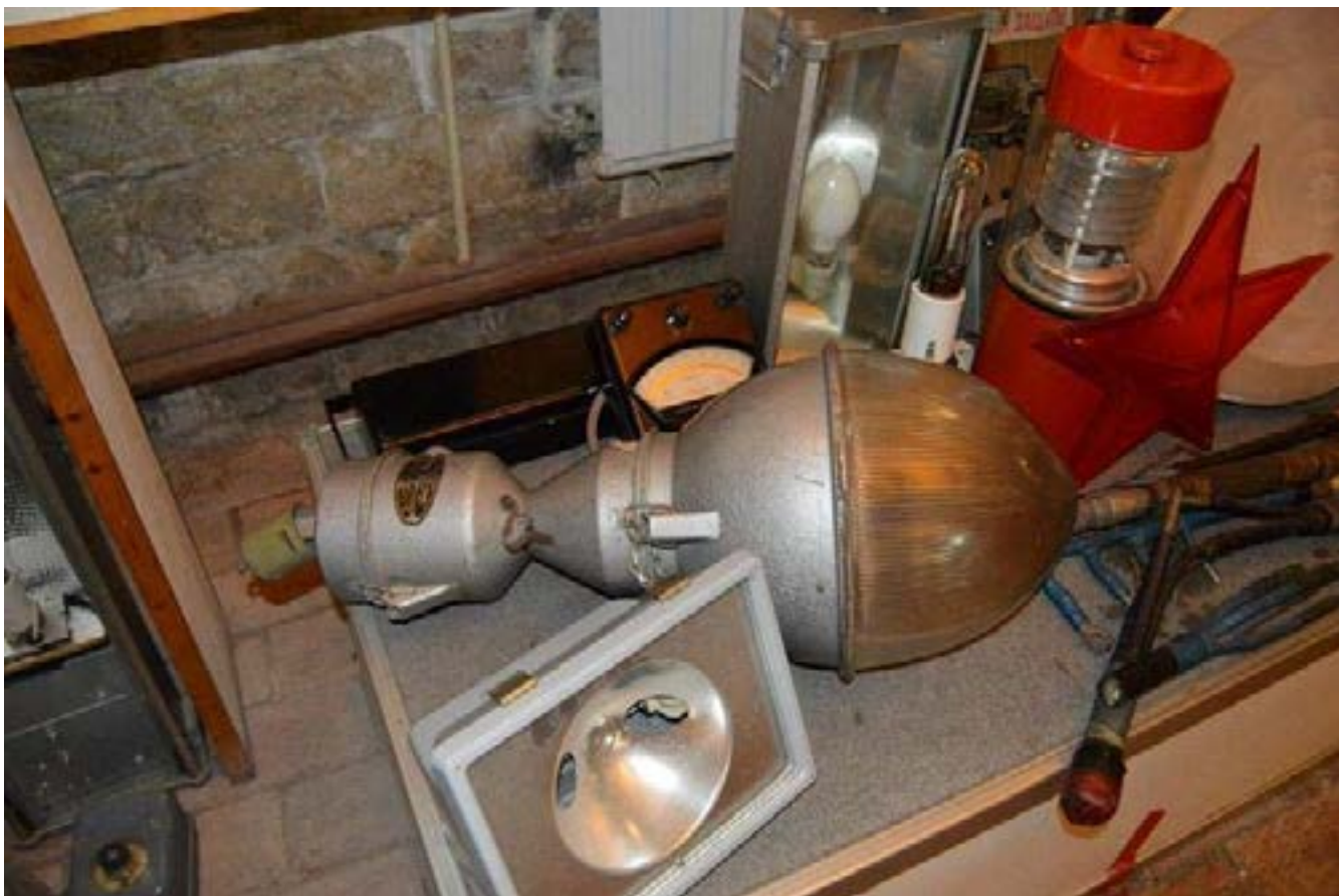
Рис. 76. «Шишкообразный» светильник поздней модели со встроенным дросселем под лампы ДРЛ. Музей «Огни Москвы».
