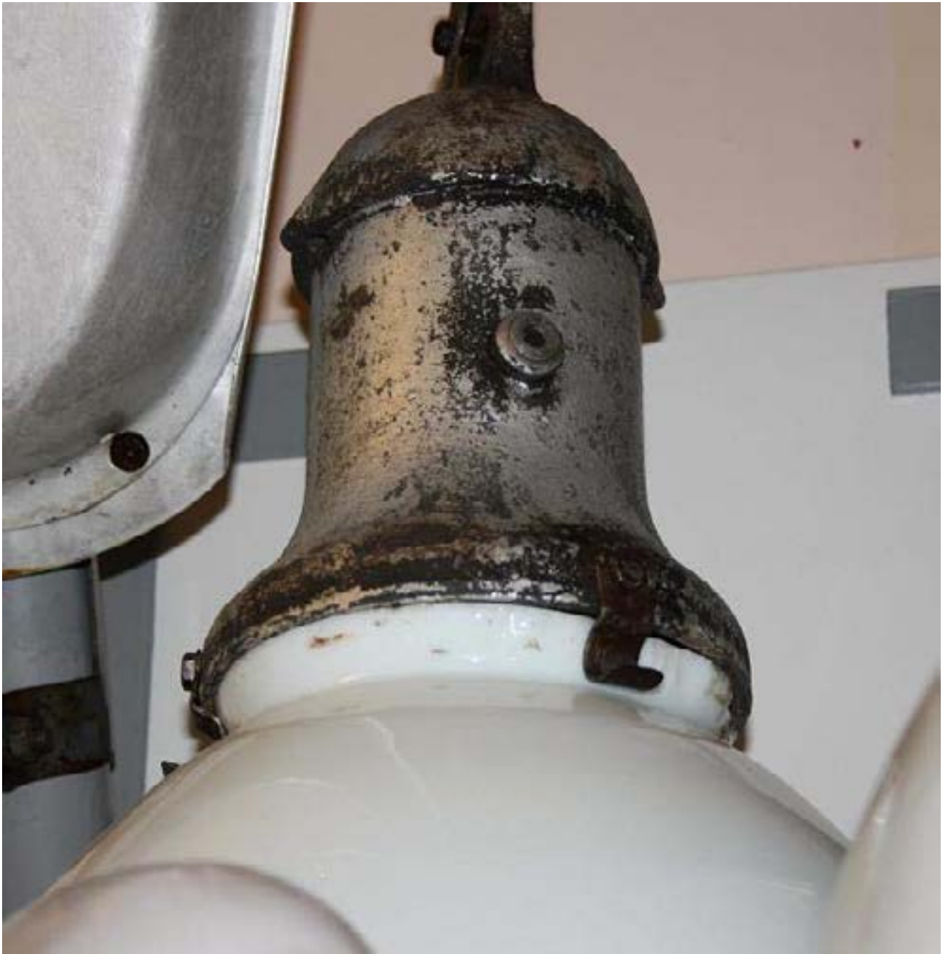
Рис. 62. Ленинградский СПО-1000. Узел крепления стекла к колоколу крупным планом. Частная коллекция светотехники Сергея Колесникова.
