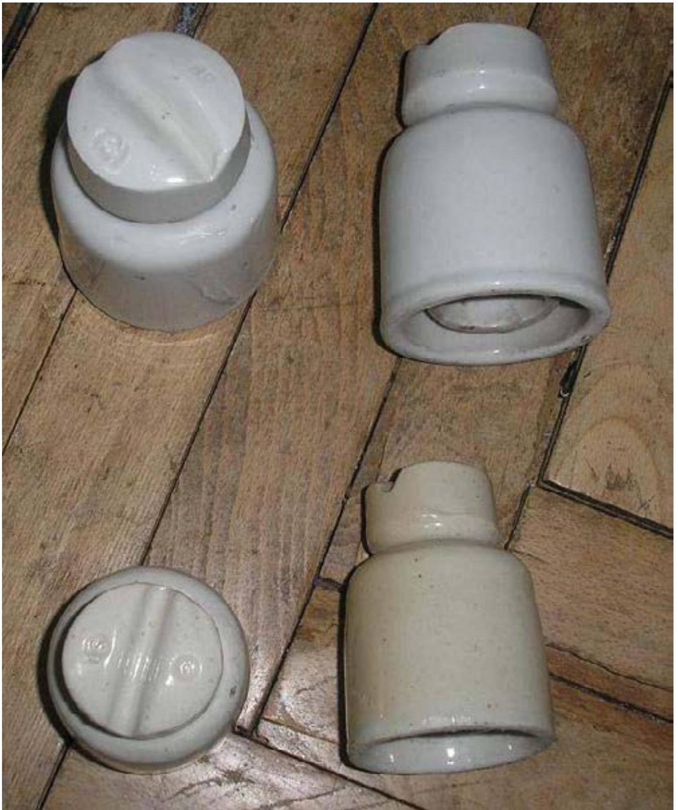
Рис. 7. Штыревые изоляторы типа ТФ. Крупный план. Из личной коллекции светотехники.
