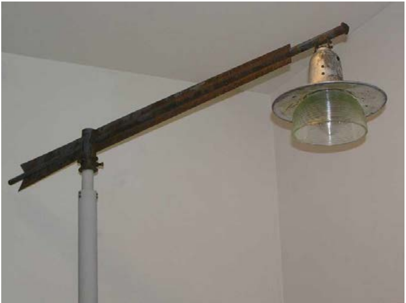
Рис. 69. Светильник СПО-200 на базе чугунного колокола. Крупный план. Частная коллекция светотехники Сергея Колесникова.
