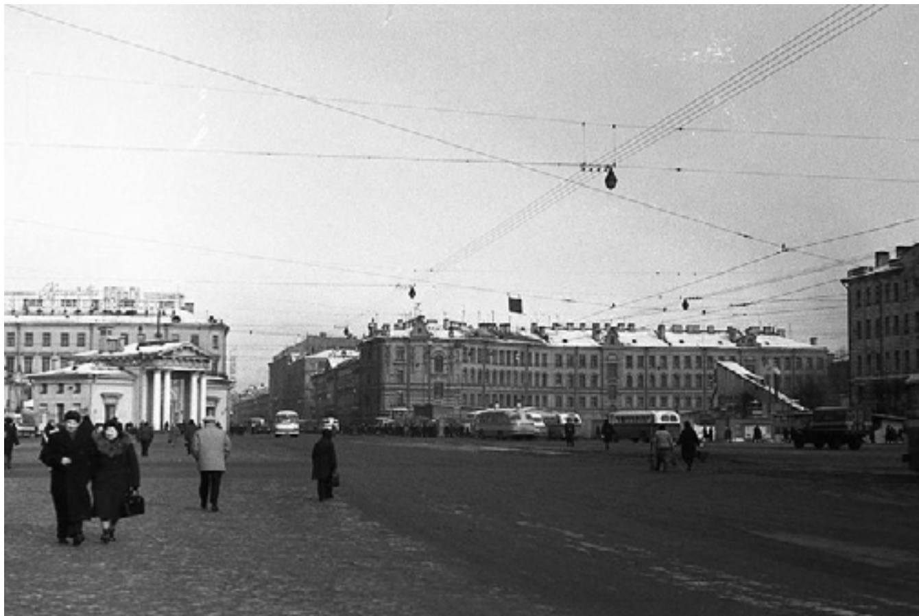
Рис. 46. Линия освещения на двухъярусных растяжках. Сенная площадь 1962 год.
