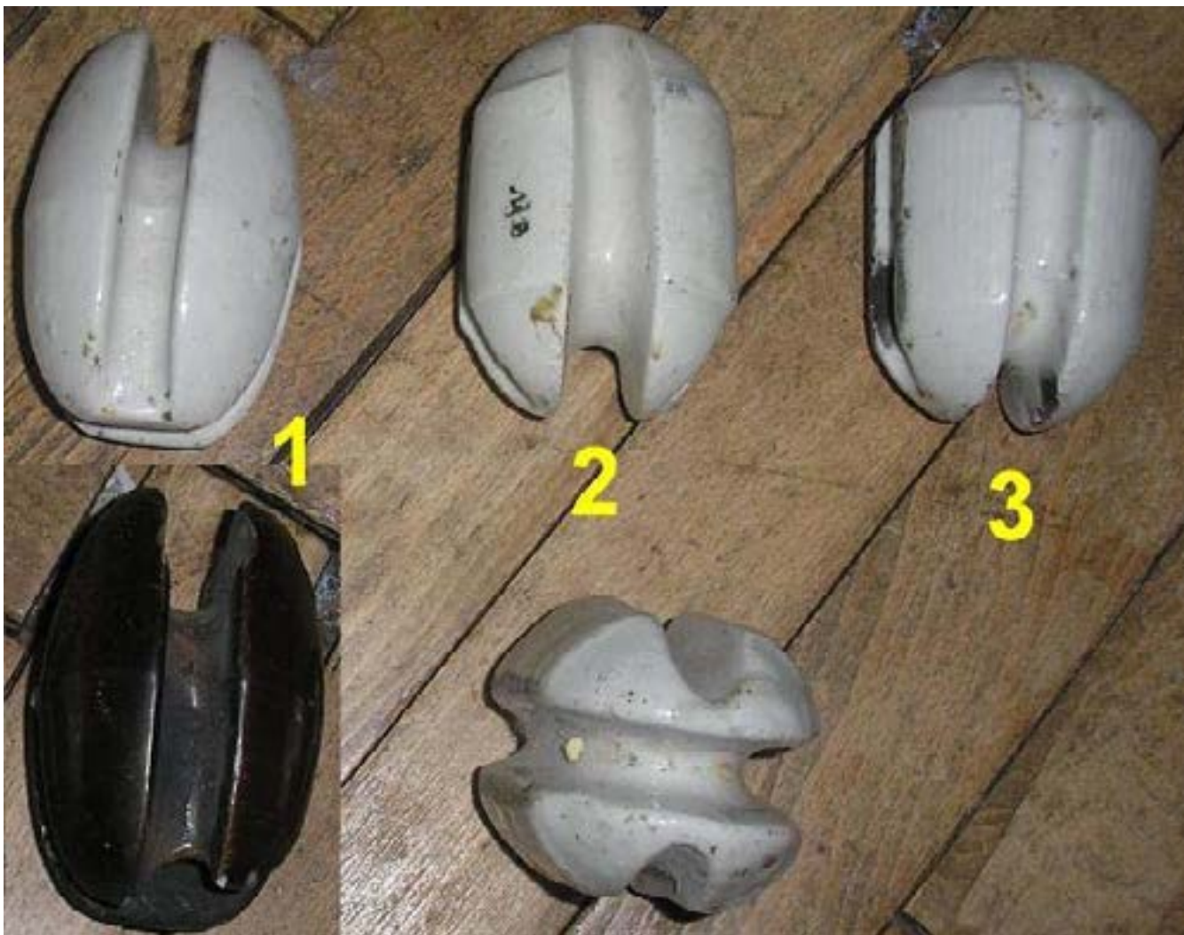
Рис. 13. Семейство первых желудеобразных такелажных (подвесных) изоляторов. Из личной коллекции светотехники.
