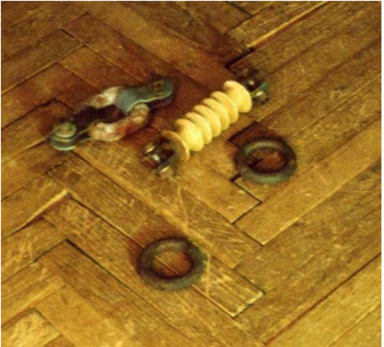
Рис. 157. Натяжной полимерный стержневой изолятор первых моделей. 24 февраля 2001 года.
