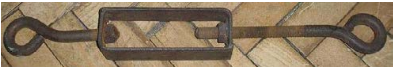
Рис. 52. Типовая натяжная муфта, применяемая в уличном освещении Ленинграда. Из личной коллекции светотехники.
