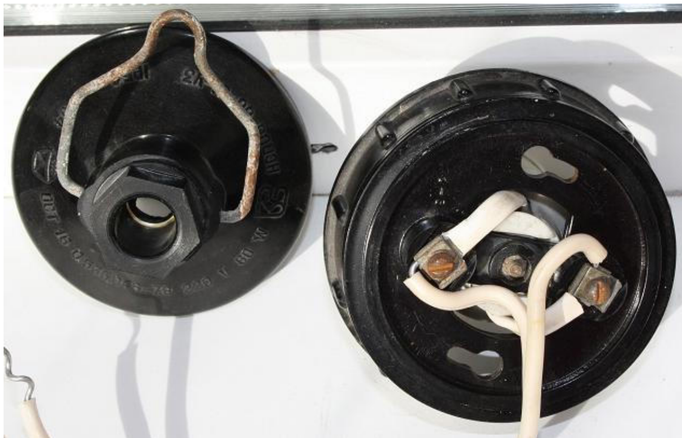
Рис. 19. Внутренности светильника НСП03-60-01-У3 (1984 год) (ВЗП).
