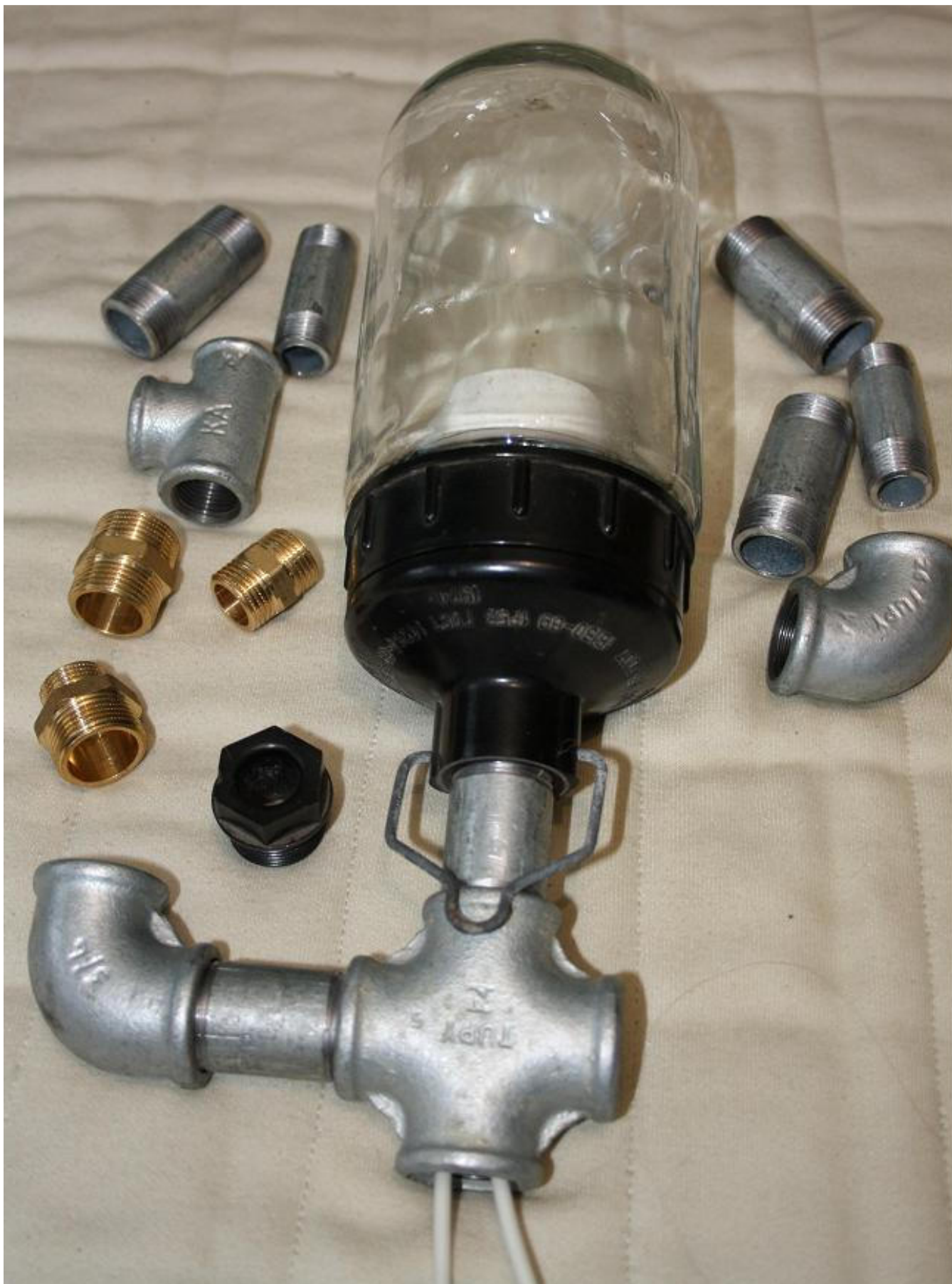
Рис. 10. Светильник НСП 03х60/Р 53-01 на водопроводной трубе.
