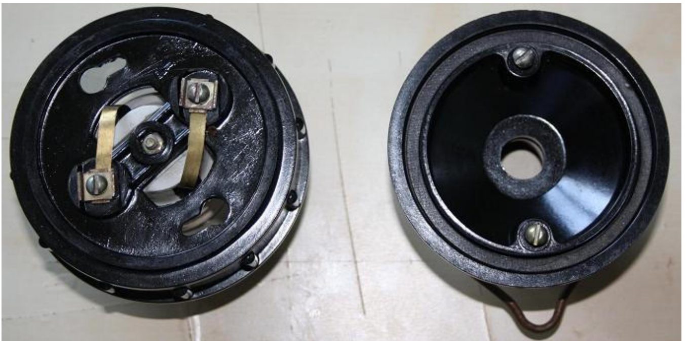
Рис. 25. «Пиратский» НСП03М-60-001У3Х2 (1986 год). Внутренности разобранного корпуса.
