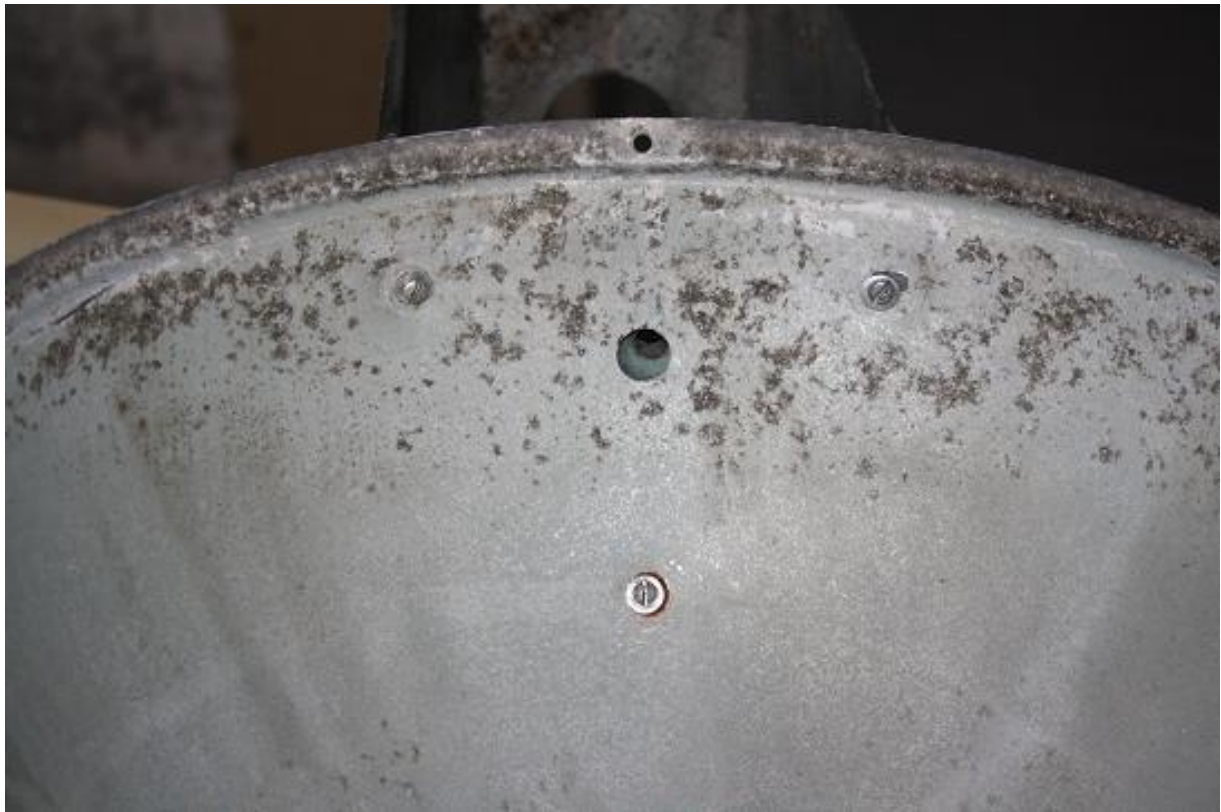
Рис. 56. Крепление отражателя к полусфере в светильниках РКУ07 и ЖКУ07 версии 4 (вид со снятым отражателем).
