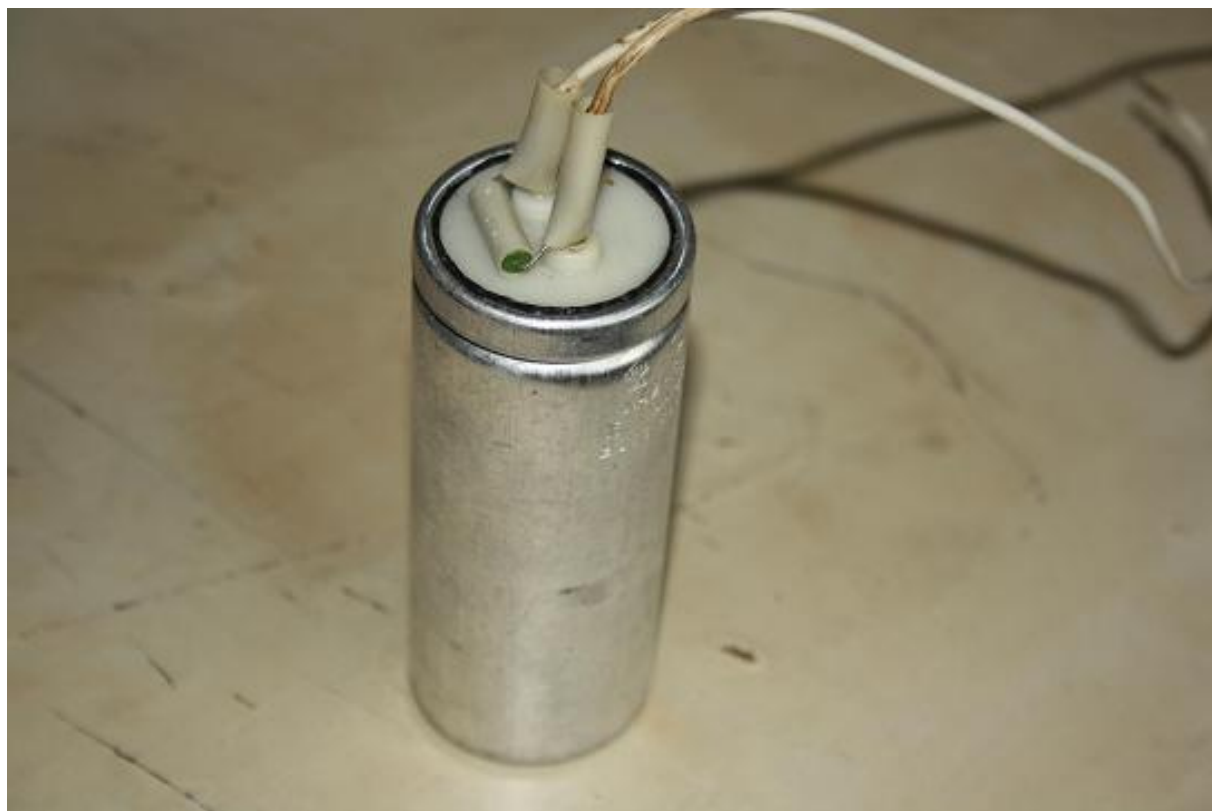
Рис. 44. Цилиндрический конденсатор К42-19. 16 мкФ 250В с разрядным резистором.
