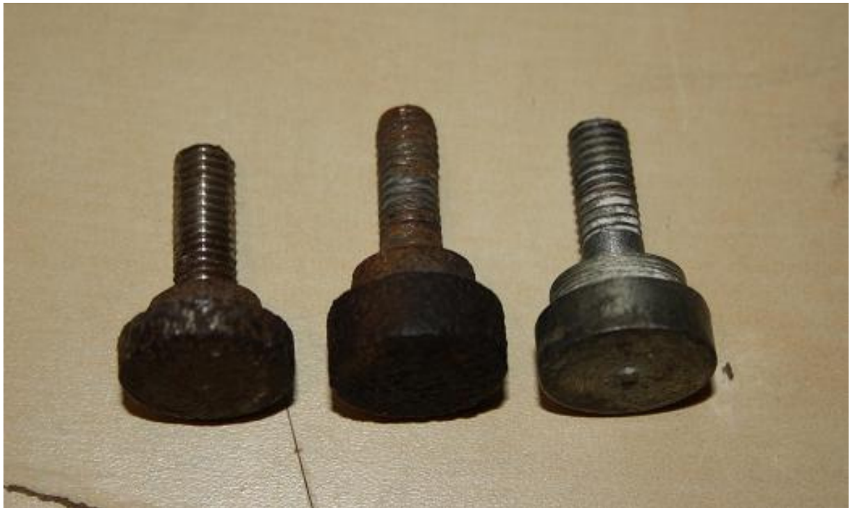
Рис. 13. Винты М6 от крышек дросельного отсека РКУ07/ЖКУ07 первых версий, с разной длиной цилиндров.
