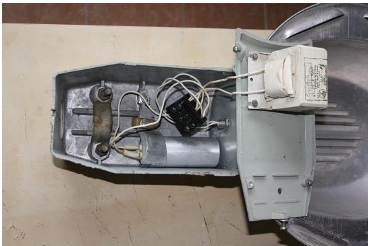
Рис. 42. Внутренности светильника РКУ07-125-002 (версия 3) (1989 год).
