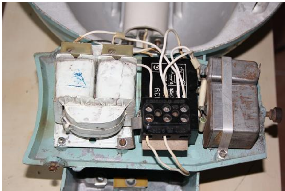
Рис. 20. Внутренности светильника ЖКУ07-100-002 (Версия 2) (1988 год).
