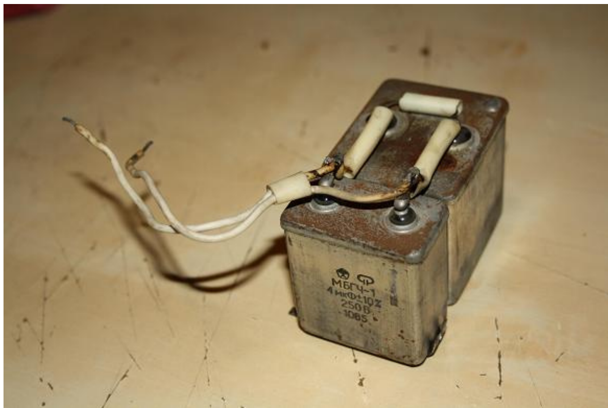
Рис. 8. Конденсаторы МБГЧ-1 10 и 4 мкФ с разрядным резистором вынуты из светильника ЖКУ07.
