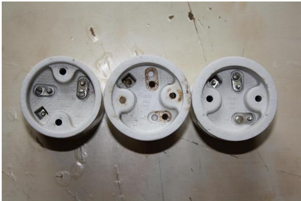
Рис. 40. Трансформация маркировки патронов ДКС-01: Слева цилиндрический – по начало 1988 года, середина – конусообразный конца 1988 года, справа - конусообразный с 1989 года выпуска и позже.
