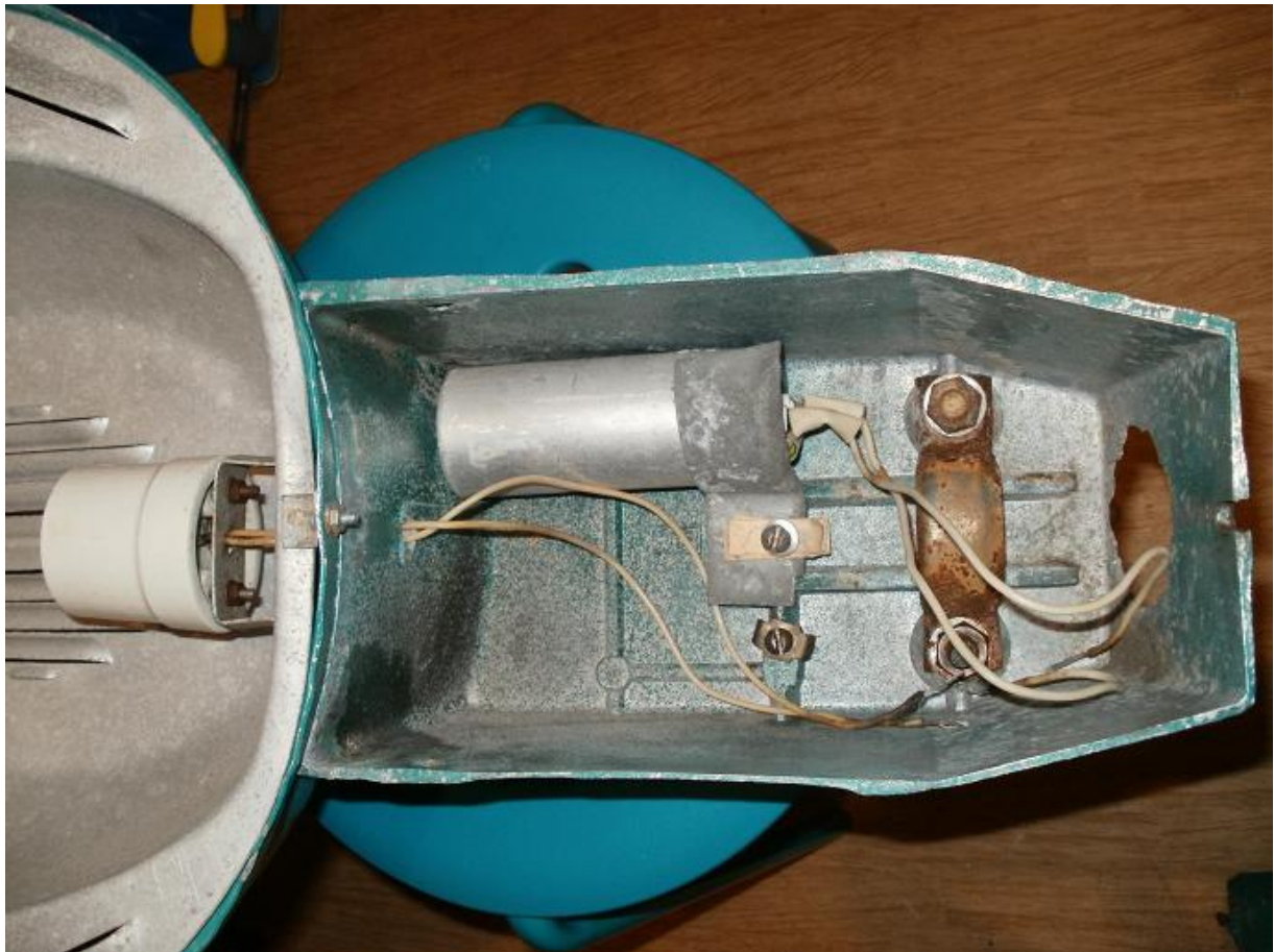
Рис. 58. Светильник РКУ07-125-002 (версия 4) на закате производства. Крепление конденсатора, и мелкие детали на дне дроссельного отсека.
