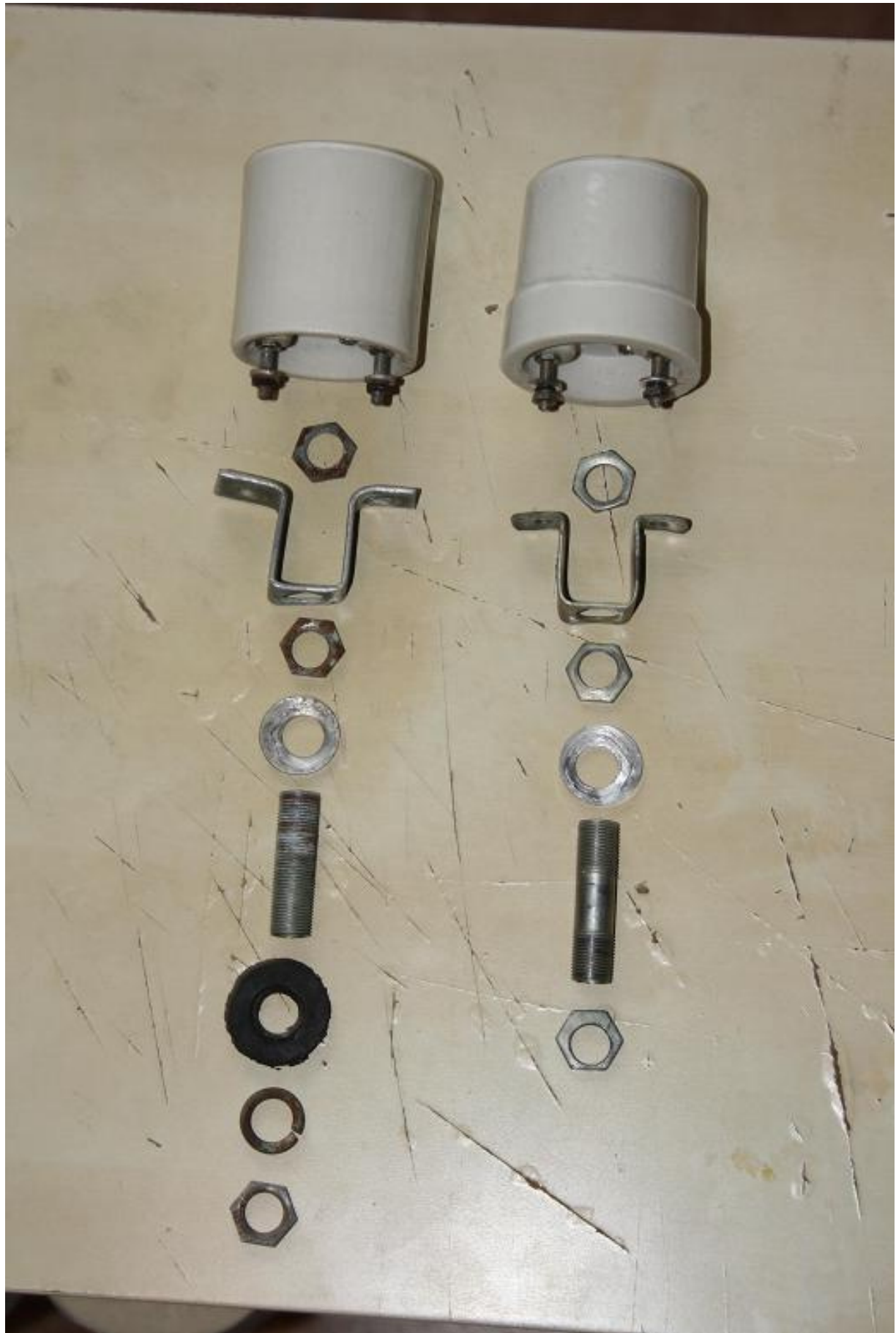
Рис. 39. Детали узлов крепления патрона ДКС-01 светильников серии «07»: версии 2 (слева), и версии 3 (справа).
