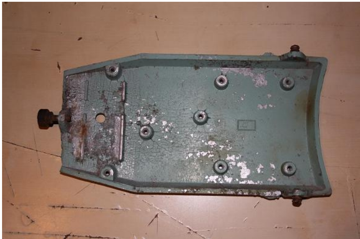
Рис. 11. Пустая крышка дроссельного отсека светильника ЖКУ07 1-й и 2-й версии. Вид изнутри.
