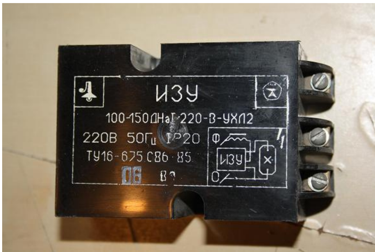
Рис. 9. Компактное 3-х выводное ИЗУ Лидского завода электроизделий на маломощные натриевые лампы 100 и 150 Вт.
