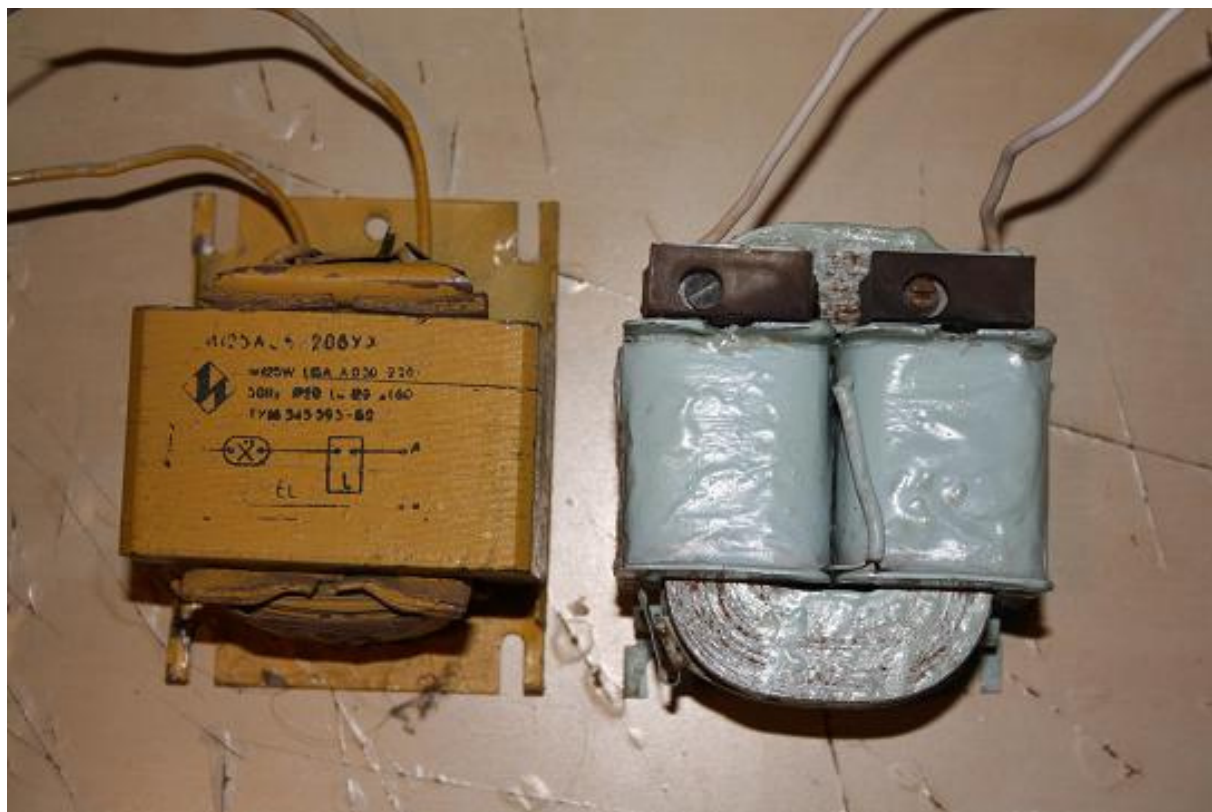
Рис. 43. Различие форм дросселей из светильников ранних и поздних версий. Слева – ИИ125А36-208УХЛ2, справа - ИИ125А36-200 УХЛ2.
